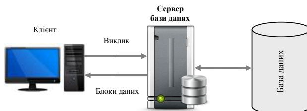
Рис. 9.6. Принцип роботи сервера бази даних
