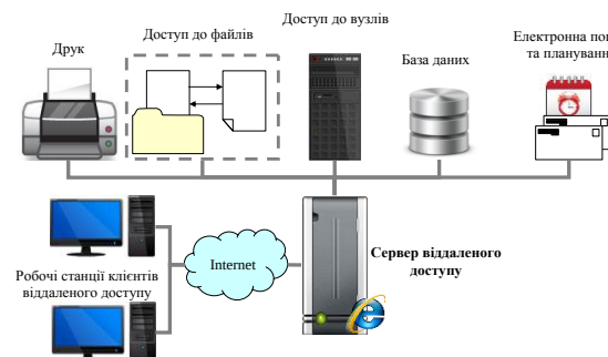
Рис. 9.12. Принцип функціонування сервера віддаленого доступу
